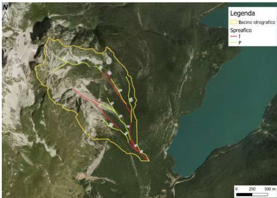
Figura 4.9 Tratti omogenei del rio per la determinazione del materiale movimentabile con il metodo di Spreafico
